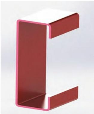
Tale profilo trova impiego nella realizzazione di forme geometriche ( Rettangolari, triangolari, trapezoidali, ecc.. ) che comporranno a loro volta la struttura portante dell'edificio.
